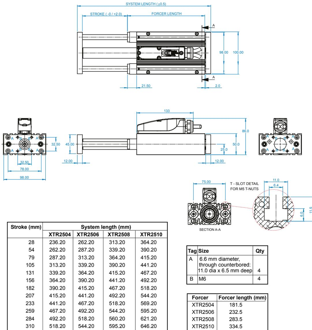
Figure 2.1 - XTR25 Outline drawings and mounting details/ XTR25 Umrisszeichnungen und Montage
