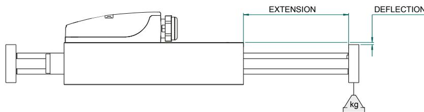
Figure C. - Mechanical Rigidity measurement arrangements/Messanordnung zur mechanischen Festigkeit
